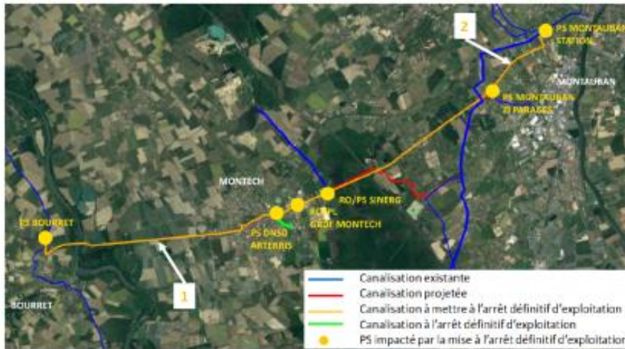
1 : Canalisation DN150/125/100 BOURRET – MONTAUBAN ZI PARAGES - 2 : Canalisation DN100/125/150 MONTAUBAN ZI PARAGES – MONTAUBAN STATION
